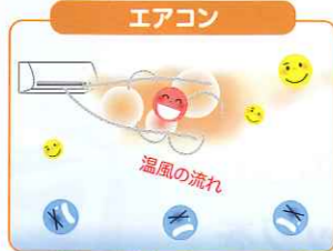
弱運転では床面まで届かないので足元が十分暖まらない
